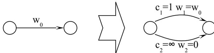
如图，将每条边拆成两条。拆开一条边上有权，但是容量限制为 1；另一条边没有容量限制，但是流过这条边就不能计算费用了。这样我们就把问题转化成了一个标准的最大费用固定流问题。
