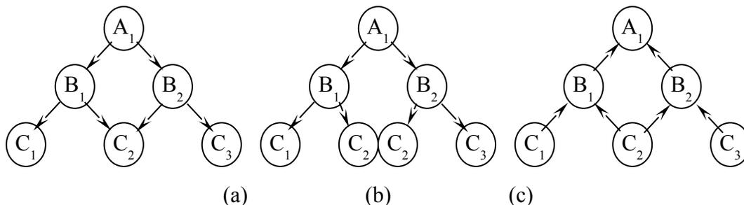
对于上图(a)这样几个状态构成的一个隐式图，用搜索算法就会出现重复，如上图(b)所示，状态  $C_2$  被搜索了两次。在深度搜索中，这样的重复会引起以  $C_2$  为根整个的整个子搜索树的重复搜索；在宽度搜索中，虽然这样的重复可以立即被排除，但是其时间代价也是不小的。而动态规划就没有这个问题，如上图(c)所示。
