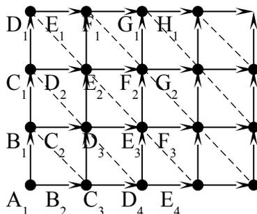
按照图中的虚线来划分阶段，即阶段变量  $k$  表示走过的步数，而状态变量  $s_k$  表示当前处于这一阶段上的哪一点（各点所对应的阶段和状态已经用  $k_s$  在地图上标明）。这时的模型实际上已经转化成了一个特殊的多段图。用决策变量  $u_k=0$  表示向右走， $u_k=1$  表示向上走，则状态转移方程如下：
