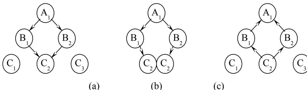
考虑上图(a)所示的隐式图，其中存在两个从初始状态无法达到的状态。在搜索算法中，这样的两个状态就不被考虑了，如上图(b)所示。但是动态规划由于是自底向上求解，所以就无法估计到这一点，因而遍历了全部的状态，如上图(c)所示。
